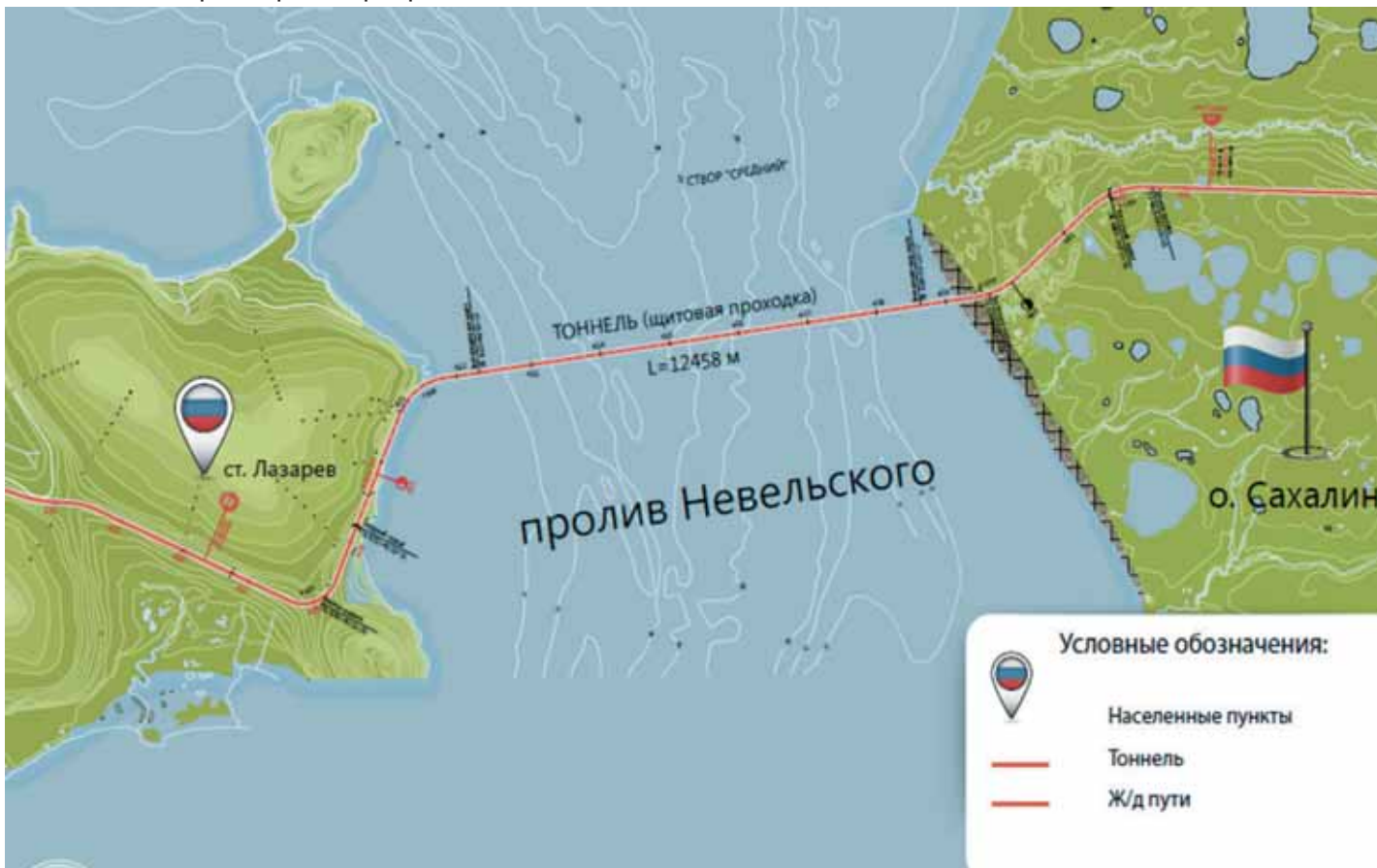
Рис. 1. Тоннельный вариант перехода через пролив Невельского
