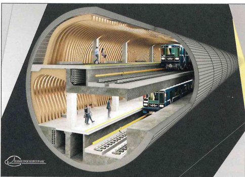
Строительство тоннеля диаметром 13 метров с размещением станционного комплекса в сечении тоннеля
