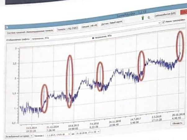
Рис. 4. Изменение нормальных тангенциальных напряжений, МПа, на ПК 148+40 (красным цветом выделено увеличение напряжений из-за проливных дождей)
