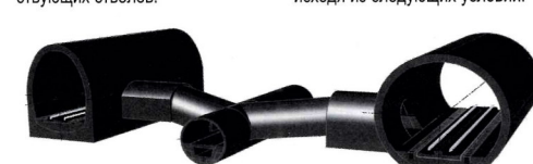
Схема расположения размещения второго Северо-Муйского тоннеля относительно существующих выработок
